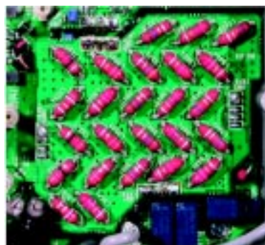
Cewki w filtrze pasmowym IC-756Pro III
