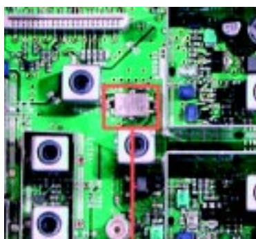
Pierwszy filtr kwarcowy, tzw. „roofing filter”
